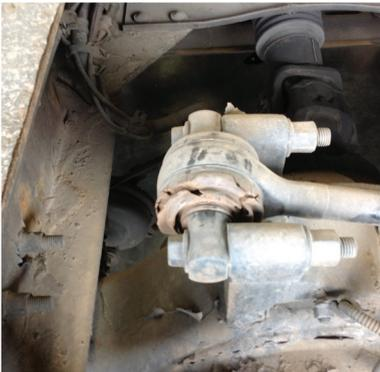
**EL MATERIAL DEL BUJE ESTÁ ROTO O AGRIETADO**
