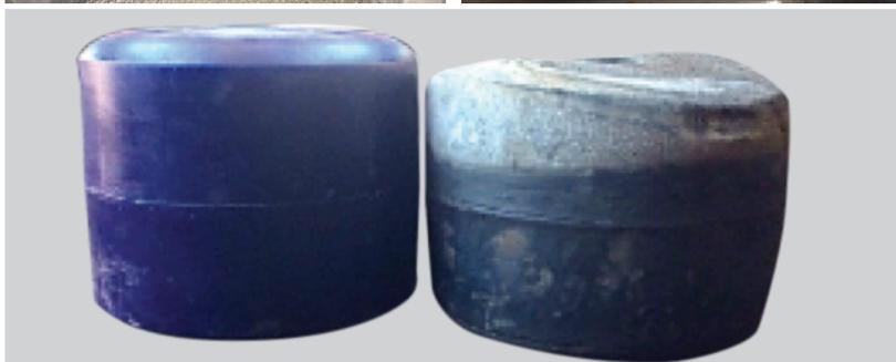
**MUELLE DE CARGA SUJETO A ATAQUES QUÍMICOS DEBE SER REEMPLAZADO CUANDO SE DESGASTE. DE LO CONTRARIO, LA ALTURA DE MANEJO SERÁ AFECTADA, CAUSANDO NUMEROSOS PROBLEMAS.**
